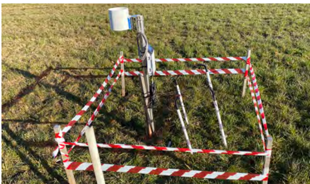
Bodenmessstation mit Tensiometern und Regenmesser
